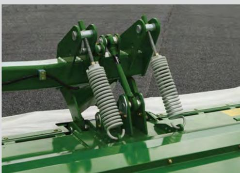
La plupart des faucheuses ne peuvent que bouger de gauche à droite pour suivre le terrain. La McHale Pro Glide est différente grâce à son système de suivi 3D et son unité de suspension qui lui permettent :
