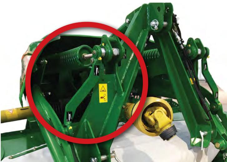
La faucheuse frontale Pro Glide est équipée d'un ressort avec compensation active breveté, qui permet d'appliquer la même pression au sol régulière, quelle que soit la hauteur de fauche.
