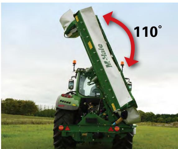
Pour le transport, la faucheuse se replie verticalement et se retrouve derrière le point central du tracteur. La hauteur de transport est réduite grâce à l'angle de repliage de 110 degrés.
