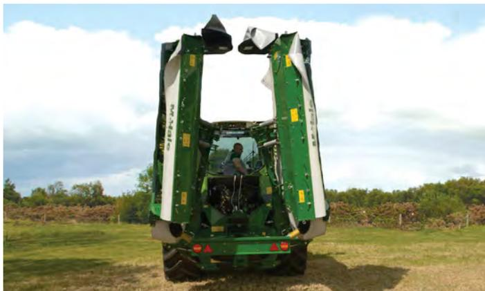
Pour le transport, la faucheuse se replie verticalement et se retrouve derrière le point central du tracteur.
