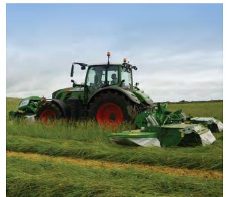
Equipée d'un système de suivi de terrain breveté, la gamme de faucheuses Pro Glide permet au lamier de s'escamoter en cas de rencontre avec un obstacle. Ceci permet de gagner en débit de chantier car la sécurité principale de la faucheuse ne se déclenchera pas à chaque obstacle. Ainsi, la vitesse de fauche peut être augmentée sans avoir à s'arrêter pour réactiver la sécurité principale.
