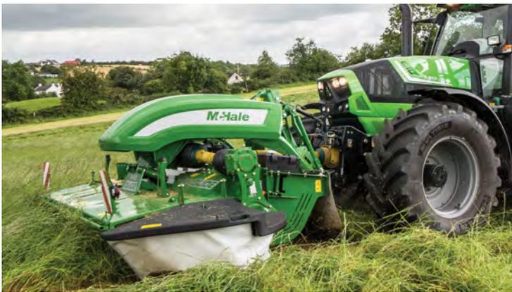
L'équipe d'ingénieurs McHale a conçu le châssis des faucheuses frontales de façon à ce que leur centre de gravité soit au plus près du tracteur. Cela permet d'obtenir une réactivité incomparable selon les conditions du terrain.
