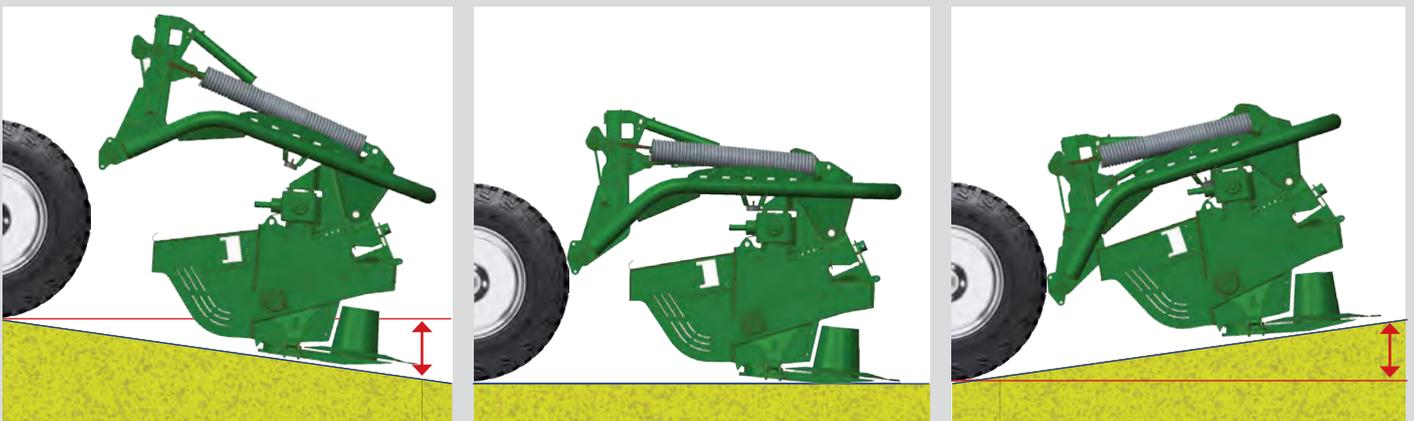
La faucheuse frontale Pro Glide possède sa propre suspension qui lui permet de s'adapter au relief du terrain grâce à un débattement vertical de 500 mm. Les mouvements de la faucheuse sont indépendants de ceux du tracteur. Lorsque vous fauchez sur un terrain très vallonné, le lamier s'ajustera automatiquement vers le bas puis vers le haut, si il rencontre un creux ou une bosse.
